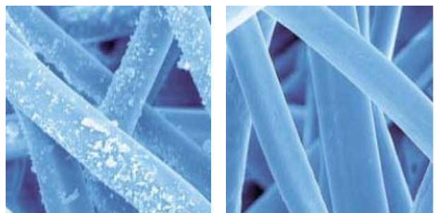
吸附了细小微粒的滤材；干净滤材 (200倍放大)
